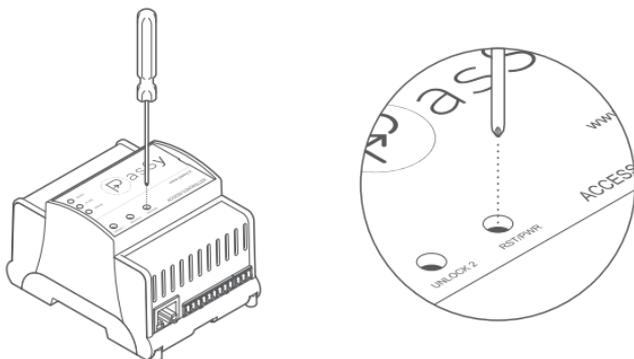
3. Dopo alcuni secondi, tutti i LED lampeggeranno in sequenza contemporaneamente e il dispositivo entrerà in modalità **Access point**, generando una rete Wi-Fi con server DHCP attivo
